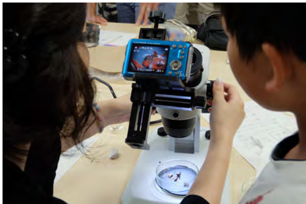
デジタルカメラアダプターを用いた顕微鏡撮影
