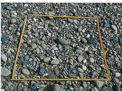
図4 枠法による調査場所の設定
